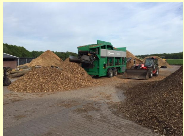
Houtsnippers worden met een speciale machine gezeefd
